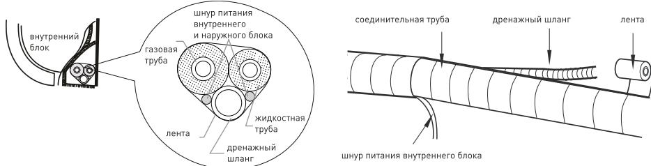
2. Оставьте запас длины дренажного шланга и кабеля питания при их обвязке, для последующего подключения. Обмотав до нужного места, отделите кабель питания внутреннего блока, а затем отделите дренажный шланг.
