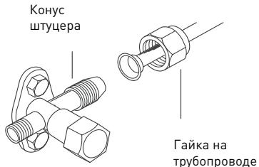
4. Затяните накидную соединительную гайку соответствующим моментом, используя динамометрический ключ, необходимый момент затяжки указан в таблице.
