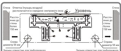
2. В зависимости от модели кондиционера выполните отверстие для трубопровода диаметром 55 мм в соответствии с выбранным местом для выходных трубопроводов. Чтобы обеспечить плавность слива следует выполнить отверстие под углом 5-10 ° вниз к наружной стороне стены.
