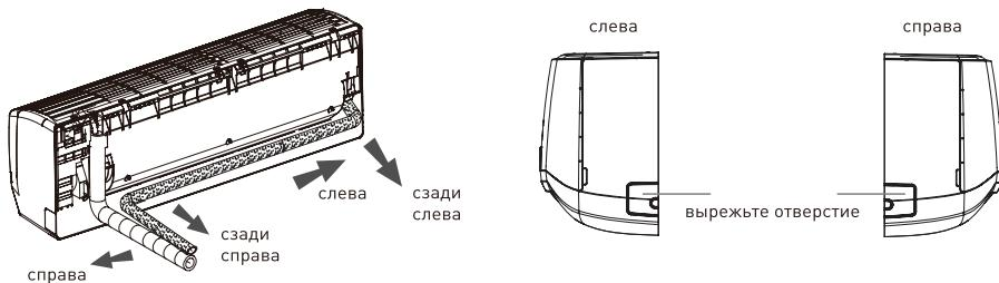
2. При выборе направления вывода трубы слева или справа, удалите соответствующую выштамповку в пластике нижней части корпуса блока.
