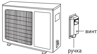
2. Снимите резьбовые заглушки штуцеров и совместите раstryбы трубопроводов и конусы штуцеров подключения.
