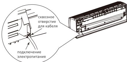
3. Открутите скобу крепления кабеля; подключите жилы кабеля питания к соответствующим клеммам на клеммнике внутреннего блока в соответствии с указаниями ниже; затяните винты, а затем закрепите кабель с помощью скобы крепления.
