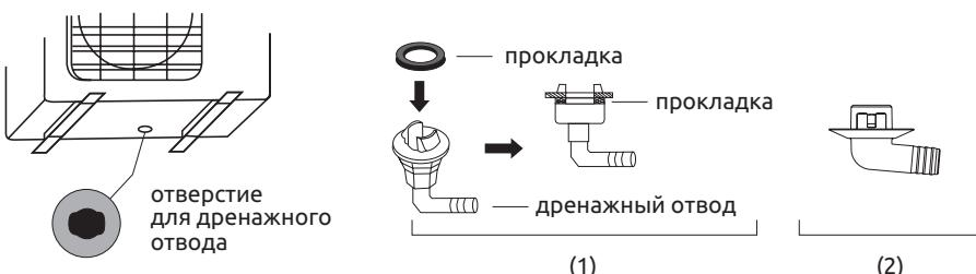
**ПРИМЕЧАНИЕ:** изображение конструкции дренажного патрубка приведено для справки. Конструкция дренажного патрубка вашего кондиционера может отличаться (например, может отсутствовать резиновая прокладка).
