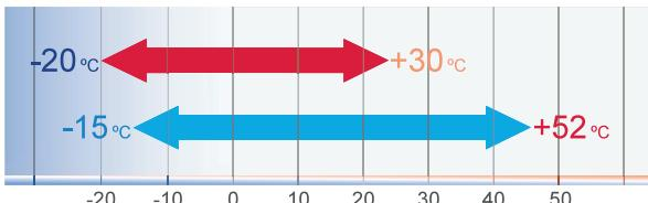
Передовые технологии расширили диапазон работы в режиме нагрева и охлаждения. Это позволяет эксплуатировать оборудование при низких температурах вплоть до -20°C при нагреве и +52°C при охлаждении.
